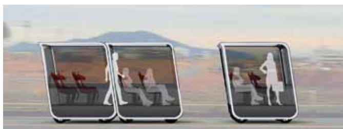
Формирование электробуса из ячеек Next Future Transportation
